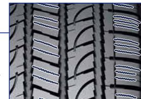
Se optimizó la disposición de los surcos del diseño para reducir el ruido que se oye en el exterior cuando el vehículo pasa y minimizar así el efecto sobre el entorno.
