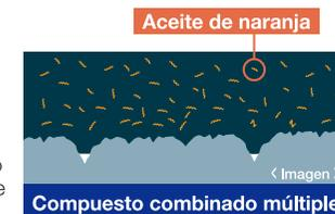
Logra un buen contacto en las pequeñas depresiones en la superficie del camino, lo que aumenta la superficie de contacto y mejora la adherencia.
