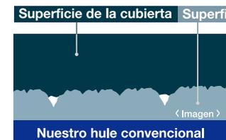
No logra un buen contacto en las pequeñas depresiones en la superficie del camino porque no es suficientemente flexible.
