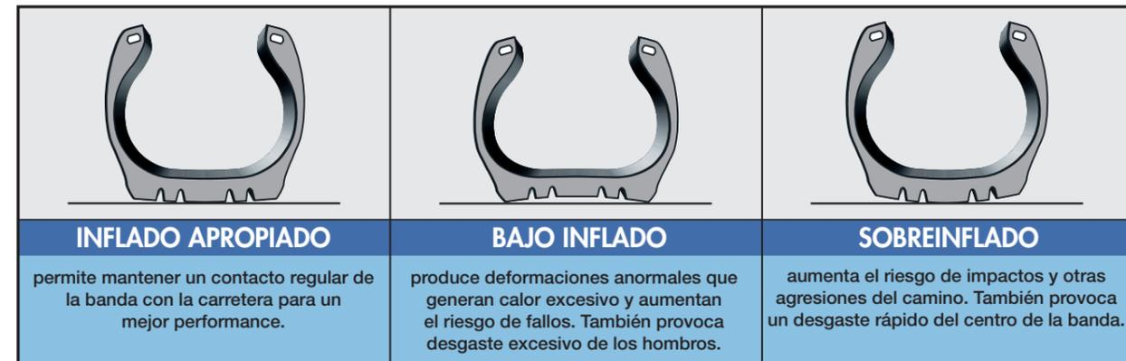
La presión de inflado debe comprobarse en frío, al menos cada dos semanas, utilizando un medidor de presión calibrado. Estas indicaciones son importantes de observar en neumáticos con perfiles más bajos, puesto que la deformación de la pared lateral es menos visible.
